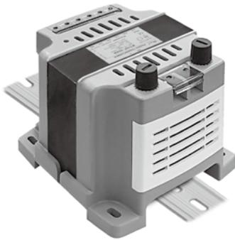
FUSED TRANSFORMER는 1차 측에 Fuse를 장착하여 제작된것으로 부하 단락 및 과부하시 TRANSFORMER 보호 및 설비의 안전 사고를 미연에 방지할 수 있습니다. 또한 DIN Rail 및 Bolt 취부 겸용으로 DIN Rail 사용시 손쉽게 장착 할 수 있습니다.
