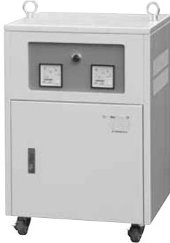
삼상, 단권형으로 일반 Dry Type으로 Casing화 하여 전면에는 Lamp V-M, A-M, NFB 등을 부착하였으며 작업자의 작업성을 고려하여 뒷면은 Door 식으로 하여 단자대 (Terminal Block)를 부착하여 작업의 편리성을 증대 하였으며 운반이 용이하도록 Panel 에는 운반용 바퀴로 제작 하였습니다.
