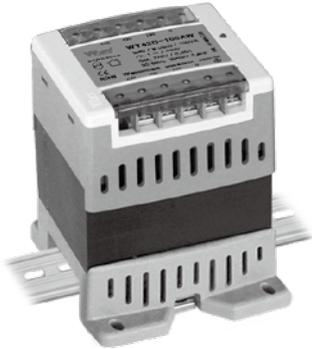
단상 복권형으로 AC 220V 이며 출력은 AC 24V로 10VA부터 350VA까지 규격화 하였습니다. AC 입력 전압 인가시 전원 표시 LED가 동작하여 소비자의 안정성을 고려한 제품입니다. DIN Rail 전용(Bolt 취부 겸용)으로 DIN Rail에 손쉽게 장착 할 수 있습니다.
