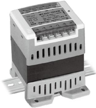
단상 복권형으로 AC 220V 이며 출력은 AC 110V로 10VA부터 350VA까지 규격화 하였습니다. AC 입력 전압 인가시 전원 표시 LED가 동작하여 소비자의 안전성을 고려한 제품입니다. DIN Rail 전용(Bolt 취부 겸용)으로 DIN Rail에 손쉽게 장착 할 수 있습니다.
