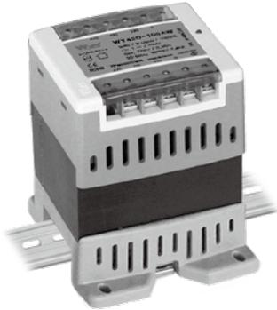
단상 복권형으로 AC 380V 이며 출력은 AC 110V로 10VA부터 350VA까지 규격화 하였습니다. AC 입력 전압 인가시 전원 표시 LED가 동작하여 소비자의 안전성을 고려한 제품입니다. DIN Rail 전용(Bolt 취부 겸용)으로 DIN Rail에 손쉽게 장착 할 수 있습니다.
