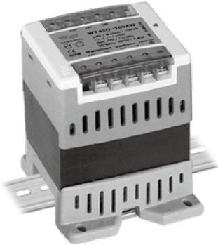
단상 복권형으로 AC 440V 이며 출력은 AC 220V로 10VA부터 350VA까지 규격화 하였습니다. AC 입력 전압 인가시 전원 표시 LED가 동작하여 소비자의 안정성을 고려한 제품입니다. DIN Rail 전용(Bolt 취부 겸용)으로 DIN Rail에 손쉽게 장착 할 수 있습니다.
