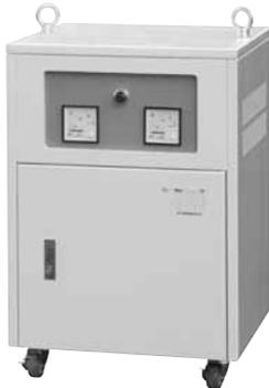
단상, 단권형으로 일반 Dry Type으로 Casing화 하여 전면에는 Lamp V-M, A-M, NFB 등을 부착하였으며 작업자의 작업성을 고려하여 뒷면은 Door 식으로 하여 단자대(Terminal Block)를 부착하여 작업의 편리성을 증대 하였으며 운반이 용이하도록 Panel에는 운반용 바퀴로 제작 하였습니다.
