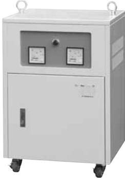
삼상 복권형으로 일반 Dry Type으로 Casing화 하여 전면에는 Lamp V-M, A-M, NFB 등을 부착하였으며 작업자의 작업성을 고려하여 뒷면은 Door 식으로 하여 단자대 (Terminal Block)를 부착하여 작업의 편리성을 증대 하였으며 운반이 용이하도록 Panel 에는 운반용 바퀴로 제작 하였습니다.
