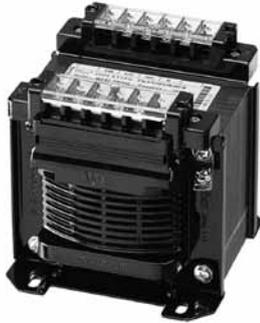
단상 복권형으로 입력 AC 440V 출력 AC 220V로, 전압 인가시 LED가 동작하여 전원의 통전상태 유·무가 표시되며 전기중 CE인증을 받은 제품으로 신뢰성과 안전성이 확보된 제품으로 경쟁력을 위하여 단일 탭(tap)으로 구성되어 있는 경제형 트랜스포머 입니다.
