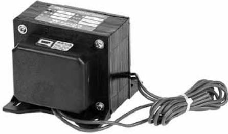
단상 복권형으로 입력은 AC220, 380/440V이며 출력은 AC24V로 Lead-Wire 및 권선보호형 카바 사용으로 분진이 많이 발생하는 곳이나 습기가 많은 곳에서 사용하기 용이 하도록 설계된 제품입니다.
