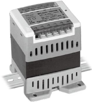
단상단권형으로 입력과 출력 전압이 한권선으로 전압탭을 인출하여 크기가 작고 가격이 저렴한 반면 사용이 제한되어 Lamp, Heater, Motor, Fan부하 등 단순 부하에 사용되거나 콘트롤 제어 위치제어 PLC, 각종 Noise에 영향을 받는 제품 사용시에는 오동작 우려가 있으니 신중하게 고려 하시기 바랍니다. AC 입력 전압 인가시 전원 표시 LED가 동작하여 소비자의 안정성을 고려한 제품입니다. DIN Rail 전용(Bolt 취부 겸용)으로 DIN Rail에 손쉽게 장착 할 수 있습니다.
